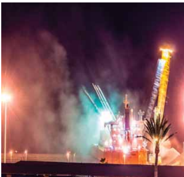
Foto de descarga nocturna de 3 de abril de 2017, donde se puede apreciar los graneles y la suspensión que provoca su movilización a cielo abierto
